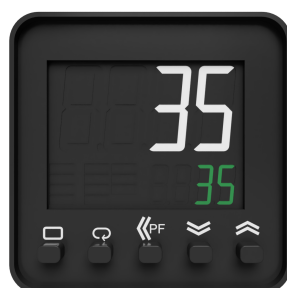
Figur 1: Grønt tall viser ønsket vanntemperatur, hvitt tall viser faktisk vanntemperatur.
