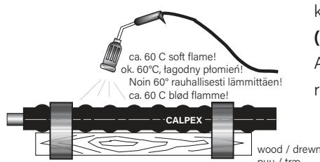
**FI FLEXSTAR-putken käsittely ja asentaminen****DK Lægning og installation af FLEXSTAR-rør****PL Układanie (zarys)**
